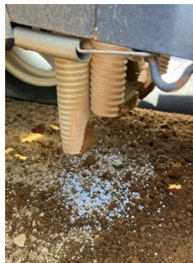
写真 2 散布された粒剤肥料(白色)とゼバ(淡褐色)の顆粒 (茨城県 2024 年 5 月)
